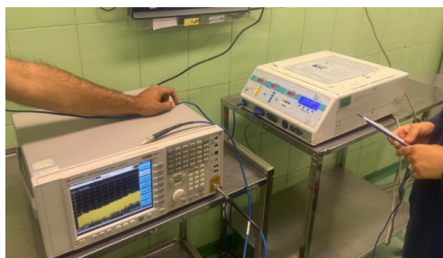
شکل ۲- ست آپ تست به وسیله دستگاه سیگنال آنالایزر srm3000
