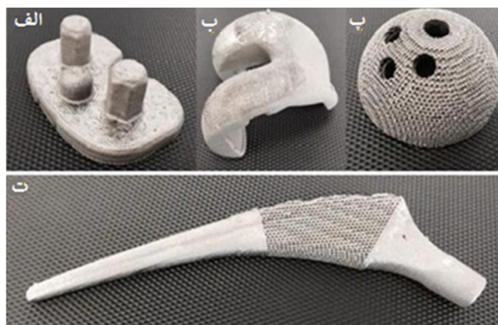
شکل ۱- الف) تری تیبیا (Tibial Tray) (ب) استخوان فمورال ران (Femoral Component) (پ) کاپ استابولار (Acetabular Cup) (ت) تنه ران (Hip Stem) ساخته شده به روش SLM (۳۴)
