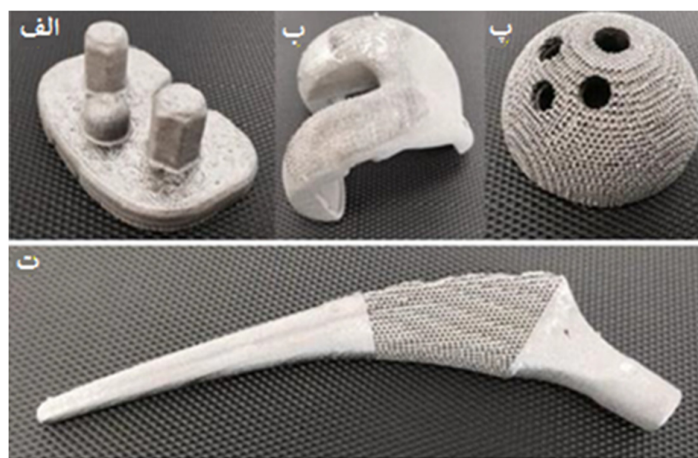
شکل ۱- الف) تری تیبیا (Tibial Tray) (ب) استخوان فمورال ران (Femoral Component) (پ) کاپ استابولار (Acetabular Cup) (ت) تنه ران (Hip Stem) ساخته شده به روش SLM (۳۴)
