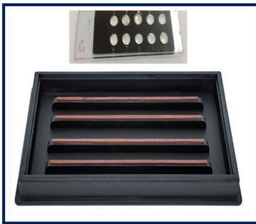
**شکل ۱** - در قسمت بالای تصویر، لام همراه قطرات نوتروفیل در چاهک‌ها را نشان می‌دهد که پس از خشک شدن با اتانول فیکس می‌شوند. در قسمت پائین تصویر جار مرطوب نمایش داده شده که از آب برای ایجاد رطوبت پس از بسته شده استفاده می‌شود و در مرحله انکوبه نمودن نمونه‌ها روی چاهک‌ها استفاده شد.
