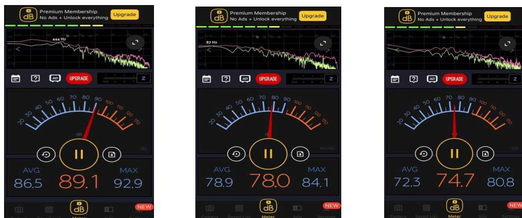
شکل ۵- چند نمونه از نمودارهای تراز صوت (dBA) در استخرهای مورد اندازه‌گیری
