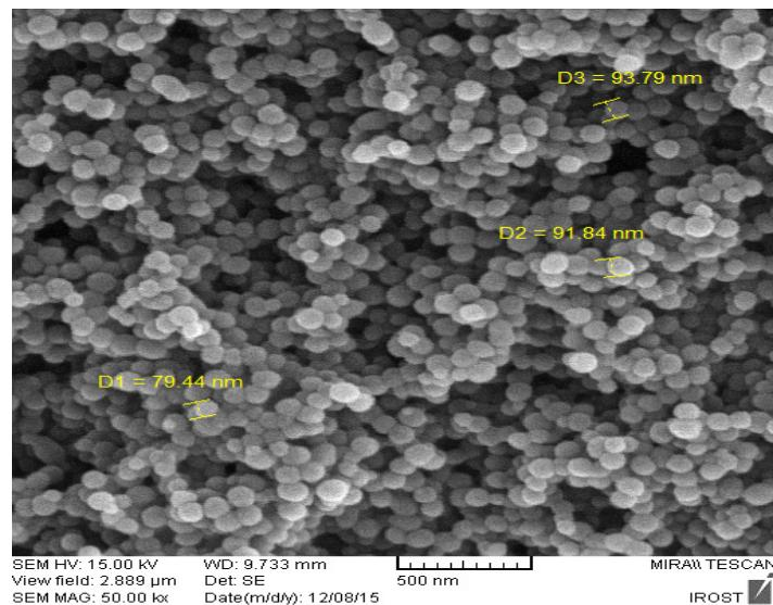
شکل ۳- تصویر میکروسکوپ الکترونی رویی از نانو ذرات کیتوزان
