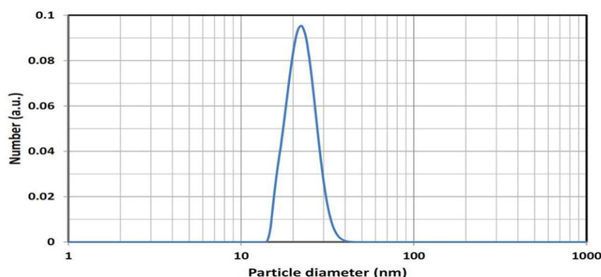
شکل ۳- توزیع اندازه نانوذرات اکسید روی سنتز شده
