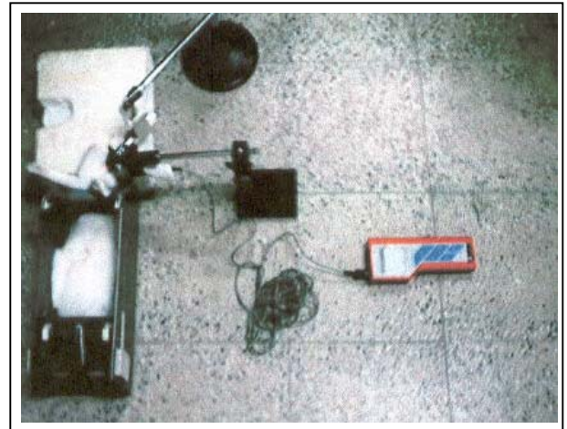
تصویر شماره ۱- شیوه نورسنجی، محل چشمه نور و لوکس‌متر در تصویر مشخص شده است.
