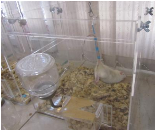
شکل ۱- قفس بی‌وزنی و مدل بی‌وزنی پاهای عقبی در موش صحرایی
