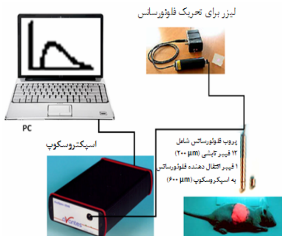
شکل شماره ۱- سیستم طراحی شده برای اندازه‌گیری سیگنال فلئورسانس به طور غیرتهاجمی و از روی سطح بافت.
