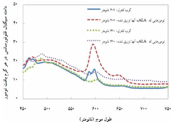
شکل شماره ۶- مقایسه دو طول موج ۴۰۷ nm و ۴۲۰ nm برای تحریک فلورسانس PpIX.
