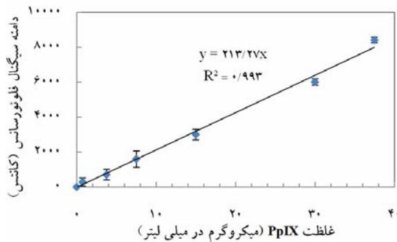
شکل شماره ۷- منحنی استاندارد PpIX تعیین شده به روش فلوئورسانس اسپکتروسکوپی، (داده‌ها نماینگ میانگین سه بار اندازه‌گیری ± خطای استاندارد است) نتایج در طول موج نشری ۶۳۵ nm و طول موج تحریک ۴۰۵ nm اخذ شده است.
