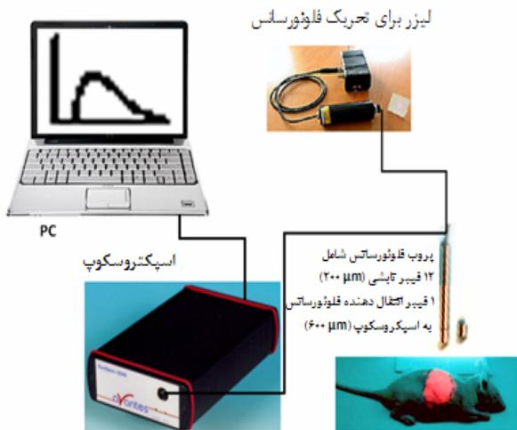
شکل شماره ۱- سیستم طراحی شده برای اندازه‌گیری سیگنال فلورسنس به طور غیرتهاجمی و از روی سطح بافت.
