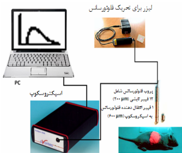
شکل شماره ۱- سیستم طراحی شده برای اندازه‌گیری سیگنال فلئورسانس به طور غیرتهاجمی و از روی سطح بافت.
