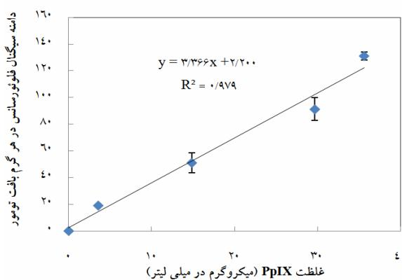
شکل شماره ۴- منحنی استاندارد PpIX (داده‌ها نماینگر میانگین سه بار اندازه‌گیری  $\pm$  خطای استاندارد است) سیگنال نشری به روش فلوریمتری و در طول موج نشری ۶۰۰ nm و طول موج تحریک ۴۰۷ nm تعیین شده است.
