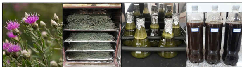
شکل ۱- مراحل عصاره گیری از گیاه تلخه ( Acroptilon repense L.)
