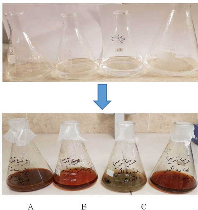
شکل ۱- سنتز نانوذرات نقره. همانطور که ملاحظه می شود پس از افزودن عصاره گیاه به نیترات نقره بی رنگ، رنگ آن به قهوه ای تیره تغییر رنگ می دهد.
