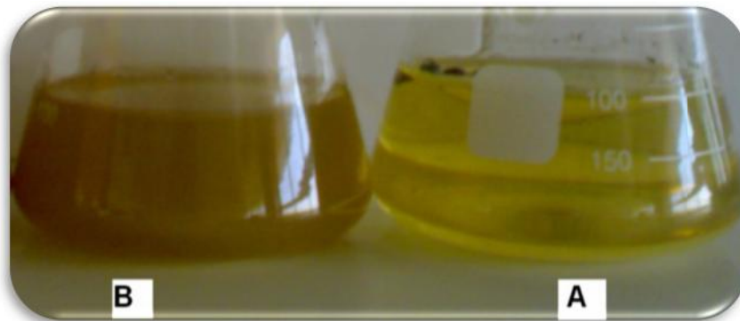
تصویر ۱- ارلن A حاوی محیط کشت شامل آنزیم های قارچی می باشد که فاقد نانوذرات نقره است و به رنگ زرد کم رنگ است. ارلن B محیط کشت مشابه ارلن A است که نانوذرات نقره در آن تشکیل شده است و به رنگ قهوه ای درآمده است.
