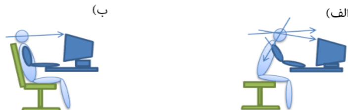
شکل ۱- الف) وضعیت نشست نامطلوب. زاویه شانه ۶۰ درجه، صندلی بدون پشتی، وضعیت خمیده به جلو؛ ب) وضعیت مطلوب زاویه کمر حدود ۱۱۵ درجه، زاویه شانه کمتر از ده درجه، وضعیت تکیه داده.
